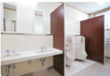
男性職員用トイレ。ブースの仕切りの天井部分を開け、外光が空間の奥に届くよう配慮。
