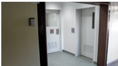
本棟1Fトイレ前室。右側はみんなのトイレ(幅2.3m×奥行3m)で広々としたつくりになっている。
