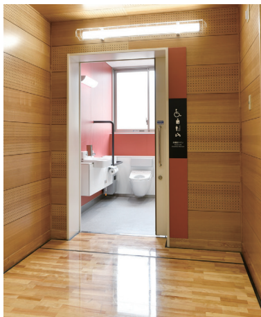
体育館内のトイレ。災害時には避難所として使われるため、ゆったりとした空間のバリアフリー設計。
