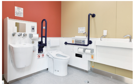
(上) 地域の人たちも使えるバリアフリートイレ。オストメイト対応流しやフィッティングボードも設えられている。 (左) 昇降口近くには「赤ちゃんの駅」。ベビーベッドといすが置かれている。
