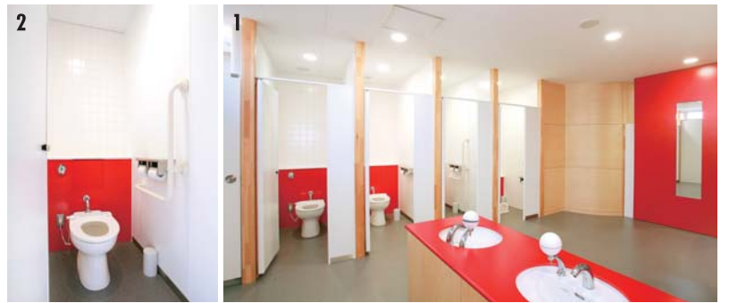
1.災害時対応も考えて、手洗いや洗顔がしやすいように大きめの洗面器を設置。 2.一般に体育館トイレは閉鎖的で暗い印象になりがち。明るくオープンな空間にするために鮮やかな色彩を採用。 3.大アリーナ横トイレは、地域の方などの利用も考慮し、遠くからでも目に付きやすいサインに。
