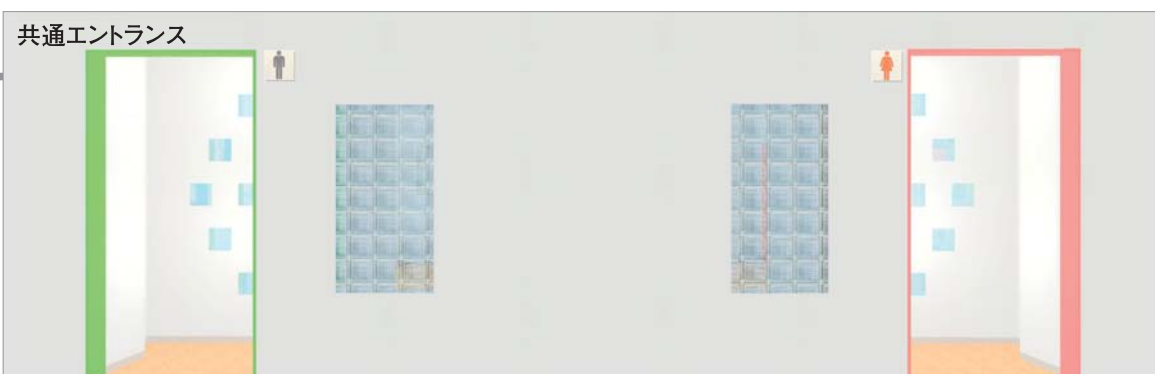
入口通路にクランクを設けて直接トイレの中は見えないように配慮し、ガラスブロックの窓を付けることで中の気配を感じられるようにした。照明を人感センサーにすることで、節電はもちろん、人の在・不在を把握できる。
