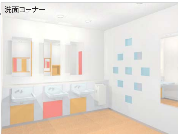
洗面コーナーは、清掃性も考慮して壁付自動水栓が付いた壁掛洗面器を設置。姿見も設けた。壁材には、耐久性があって豊富な色柄が選べる高圧メラミン化粧版、床材にはUV硬化樹脂層が汚れをガードする超防汚性ビニル床シートを採用。
