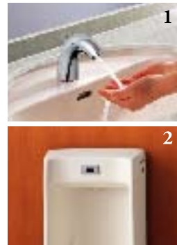
1. 手を差し出すとセンサーが反応する自動水栓は止め忘れも防げる上、少ない水量で手が洗える工夫もされており、節水に大きく貢献する。 2. 人が立つと前洗浄を行い、離れると後洗浄を行う自動洗浄小便器。学校では連続使用が想定されるので、大阪府では後洗浄のみに設定。
