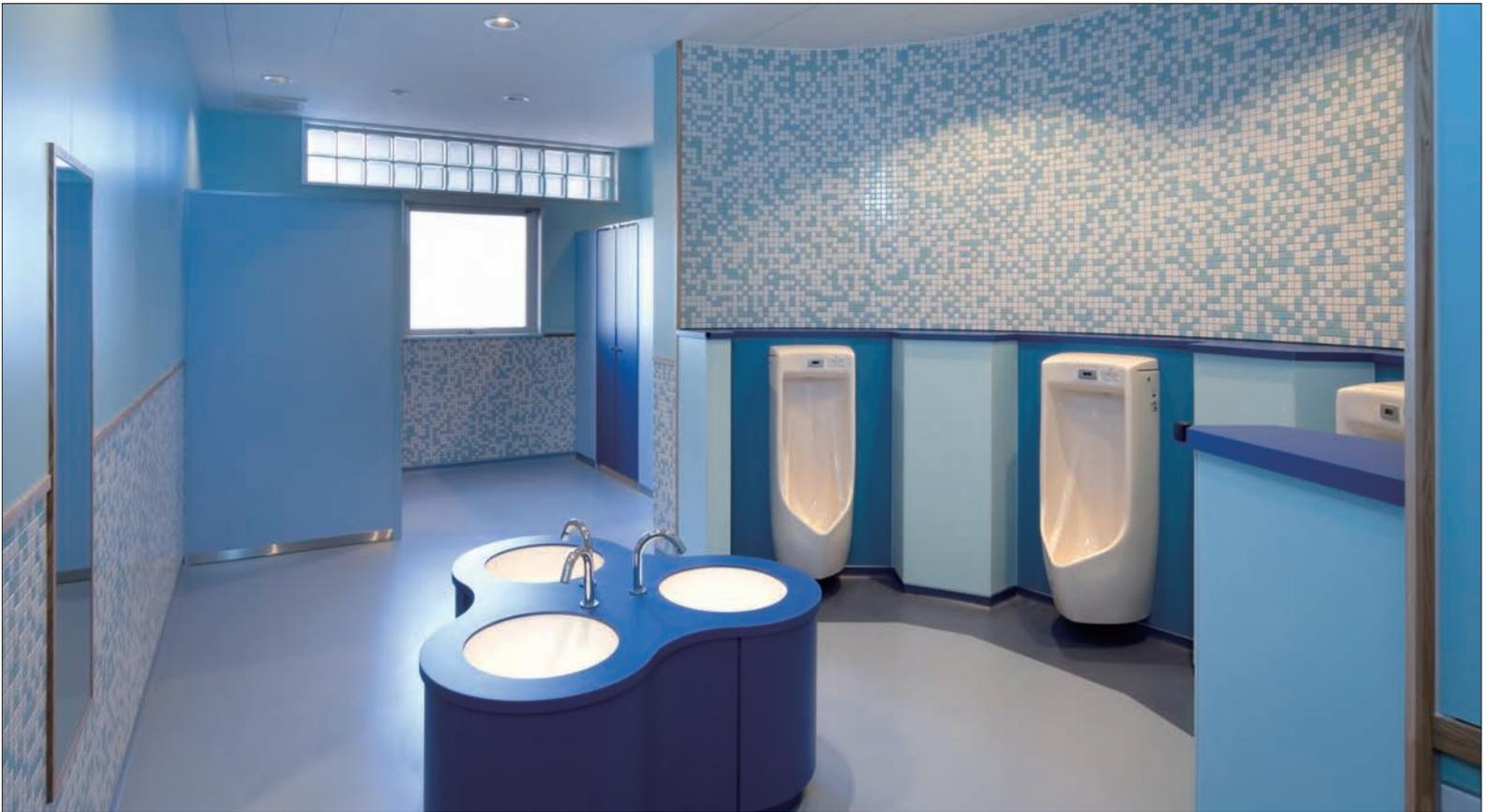
男子用トイレは青がベース。掃除は乾式。床材が壁に沿って少しだけ立ち上がっていて、より掃除がしやすい。小便器は、尿石の付着を抑えるタイプを設置。
