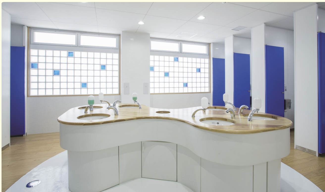
トイレは南側に設置。ガラスブロックを設え、明るさを確保するとともに意匠にも配慮。上部は換気ができるよう窓をつけている。男子トイレもすべて洋式便器の個室に。
