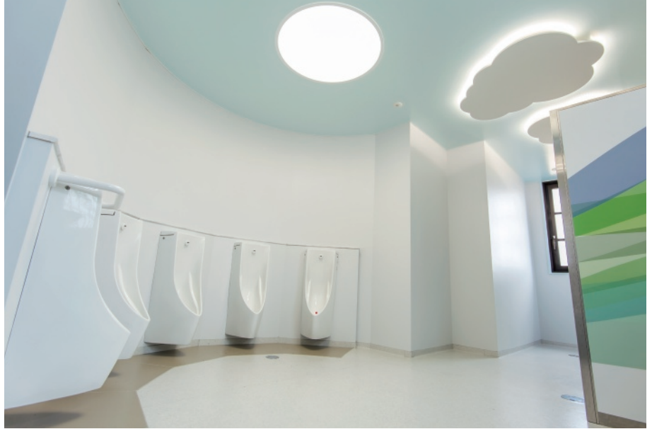
3F男子トイレ。「空」をイメージした空間で、照明によって雲が浮いているように見える。小便器下の汚垂れ石は、児童が一步前に出るように奥行きを短めに設定している。
