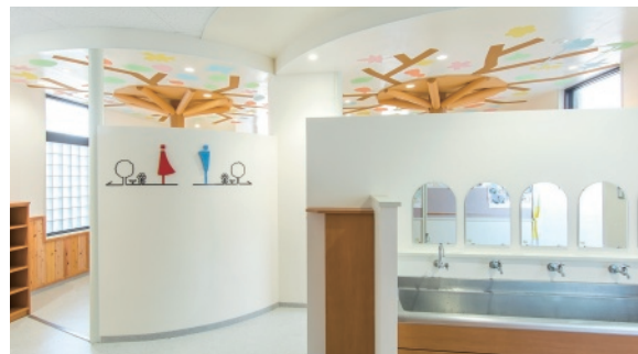
2Fトイレの入り口。ドアは設けずにゆるやかに廊下とつながっている。天井にRの段差をつけることで奥行きを出している。
