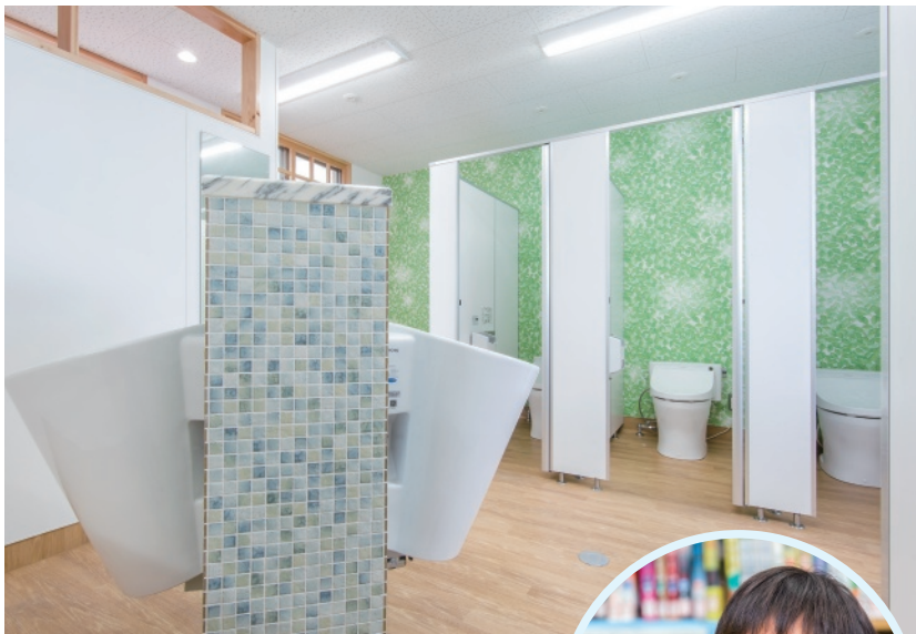
4F女子トイレ。壁はメンテナンス性の高い化粧板や植物柄のクロス、床材は木目シート、洗面台はモザイクタイル。多様な素材が融合し、楽しい空間を演出。
