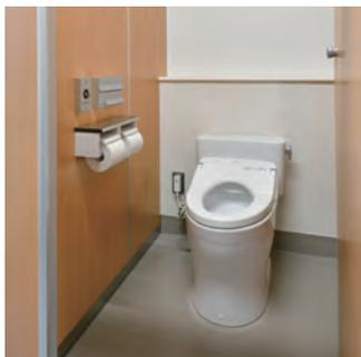
女子トイレ。すべてのトイレには手をかざすだけで洗浄が可能なセンサースイッチと、自己発電式リモコンが設置されている。
