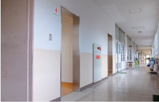
南棟2階東男女別トイレ入り口。感染症対策の観点から、ドアレス仕様に。
