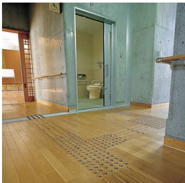
地域開放用多目的トイレ。フローリングの床に同じ素材で点字ブロックが施されている。
