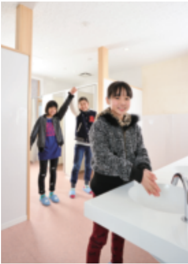
手洗いは自動水栓で節水に配慮している。
